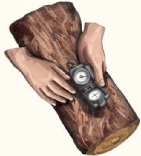
Figura 50. Medición de la inclinación y orientación
