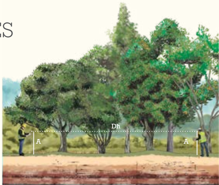
Figura 8. Medición de ángulos de inclinación con clinómetro
