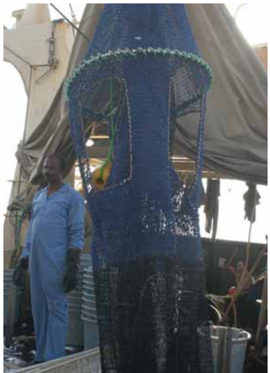
El diseño del RED permite que los peces naden hacia adelante del copo y escapen a través de las grandes aberturas de escape.
