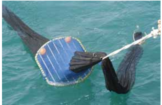
Las correas de izado pueden evitar que la captura alcance al copo y ahoguen tortugas si se localizan delante del TED.
