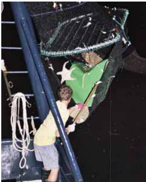
Si los cabos de izado se colocan entre el TED y el copo la remoción de esponjas y déritos de la red es una tarea simple.
