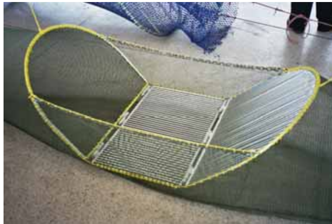
El JTED es un BRD que filtra de la red pequeños peces, incluyendo peces de desecho, pero no camarones grandes.
