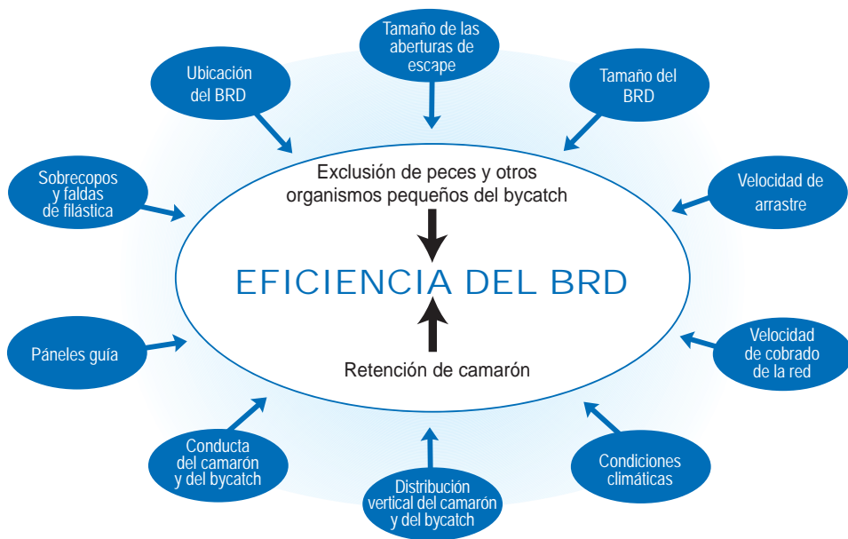
Diferentes parámetros que influyen en la eficiencia y funcionamiento del BRD.
