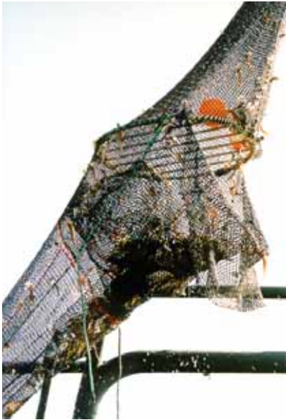
Las Parrillas ovales se ampidan bien a la forma cilíndrica del copo. Observe que la abertura de escape se extiende en parte rodeando los lardos de la parrilla.
