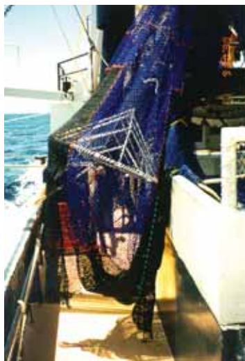
El TED de pirámide fue diseñado para excluir animales grandes a través de aberturas de escape ubicadas en la parte superior e inferior del copo. La pérdida de camarón fue alta debido probablemente a que la parrilla era muy pequeña y las coberturas de escape fueron fijadas muy apretadamente al copo.
