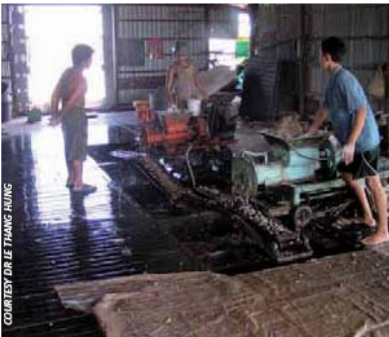
利用小杂鱼和其他成分为鲶鱼网箱养殖制备“渔场制作”饲料 (1)。
