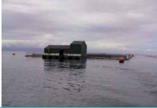
图9 网箱上可供船员住宿和存储饲料的漂浮驳船/棚屋
