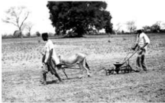
L'âne au semoir, prototype Fabre, Bambey 1930
