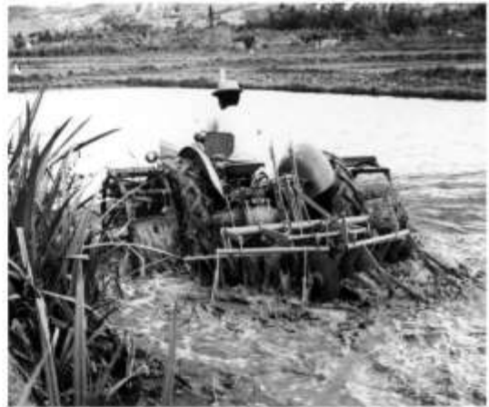
Piétinage mécanique de la rizière au paddy disk harrow Lac Alaotra (Madagascar)
