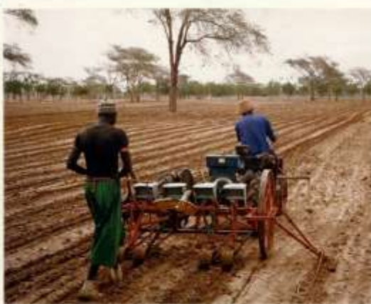
Semis de l'arachide . Semoir à quatre rangs tracté par un motoculteur , CRA Bamby (Sénégal)
