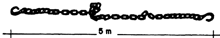
Figura 18. Cadena con ganchos para madereo con bueyes.
