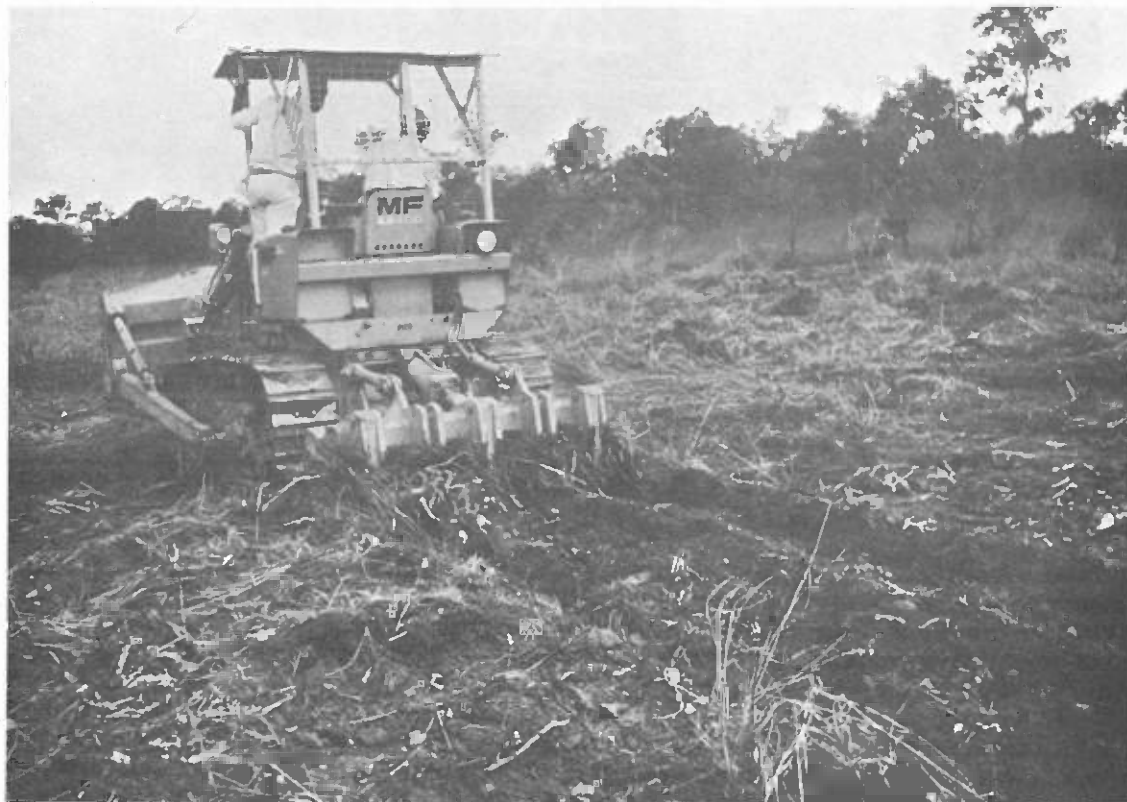
Les horizons de sol induré peuvent être brisés par sous-solage pour améliorer l'infiltration de l'eau et la pénétration des racines des plants forestiers. La surface du sol n'est pas retournée. (Photo T.G. Allan)
