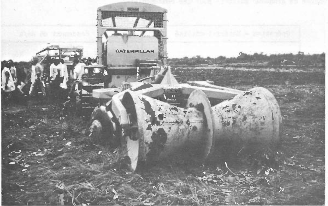
On peut améliorer le drainage superficiel et les conditions de la microstation en utilisant un billonneur à disques et un rouleau spécial pour façonner des ados de plantation. (Photo T.G. Allan)
