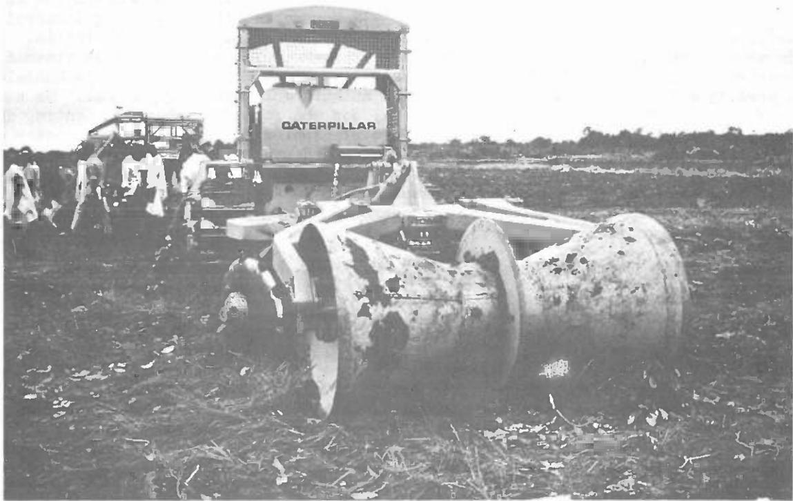
El drenaje superficial y las condiciones de la micro-estación pueden mejorarse utilizando una grada y un rodillo para la preparación de bancales elevados para la plantación. (Cortesía de T.G. Allan).
