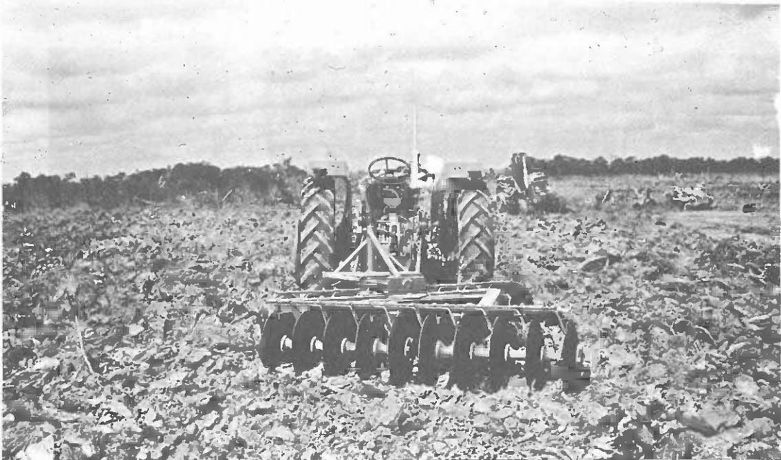
A continuación del arado, el laboreo puede mejorarse mediante un gradeo previo a la plantación con una grada de discos inclinados. Un tractor de ruedas es un equipo propulsor conveniente para esta operación. (Cortesía de T.G. Allan).
