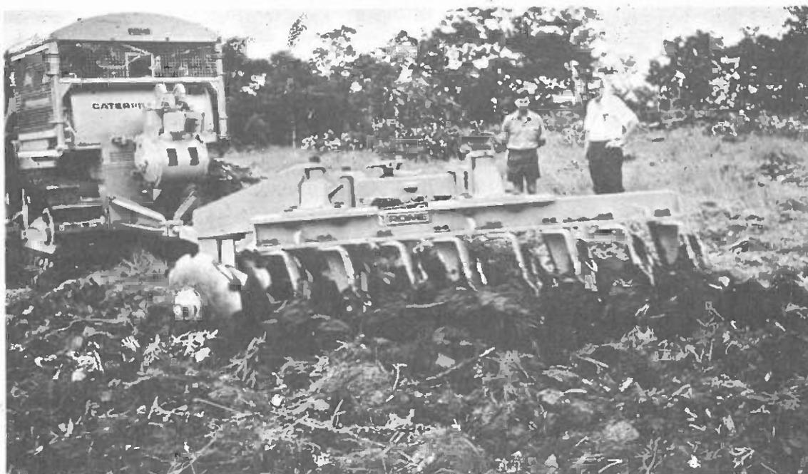
Para el arado de desmonte se utiliza el arado reforzado de grada de discos con inclinación tirado por un tractor de cadenas. (Cortesía de T.G. Allan).
