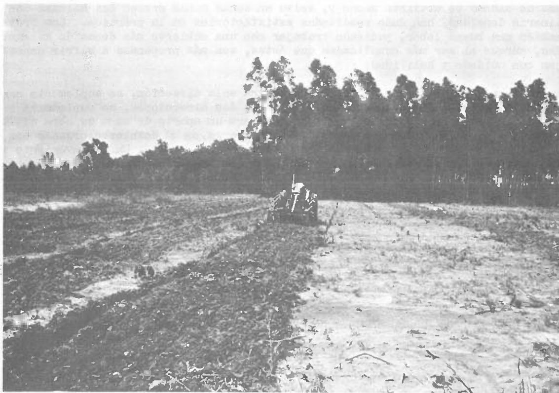
Un tractor de ruedas con una grada de discos acoplada detrás, se utiliza para el deshierbe entre líneas en plantaciones jóvenes de pino y eucalipto en las sabanas africanas. (Cortesía de T.G. Allan)
