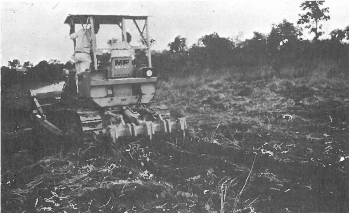
Las capas de suelo endurecidas pueden romperse mediante subsolado para mejorar la infiltración del agua y la penetración de las raíces de las plantitas. No se voltea la superficie del suelo. (Cortesía de T.G. Allan).
