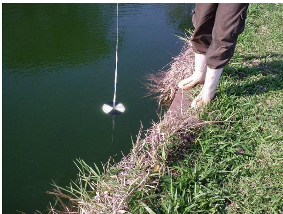
Foto N° 33. Momento de la medición de la transparencia con el disco de secchi. La cuerda que sostiene el disco está graduada en centímetros y la turbidez es medida a la profundidad en que ya no es posible ver el disco (profundidad de extinción de la luz).
