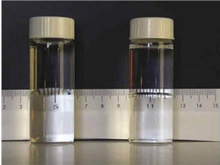
Foto n° 9. Frascos esterilizado para trasportar el agua al laboratorio para su análisis.
