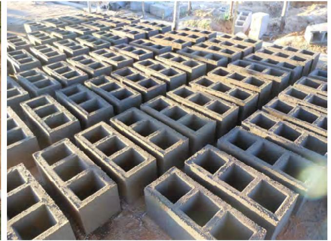
Parpaings fabriqués sur le site du magasin en construction.
