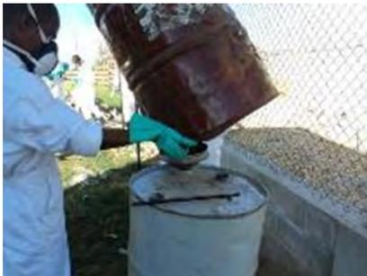
2. Le nettoyage externe : pour ne pas introduire dans le compartiment de lavage des déchets additionnels pouvant se détacher des fûts.
