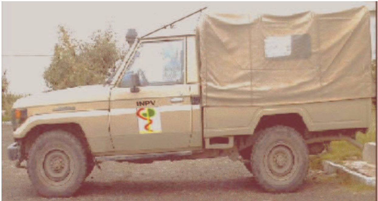
Photo n°2: Véhicule léger de prospection monté d'un dispositif radio
