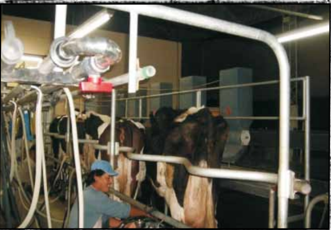
f Foto 3.9. Tambo completo con espina de pescado, línea de leche y enfriador a placa.
