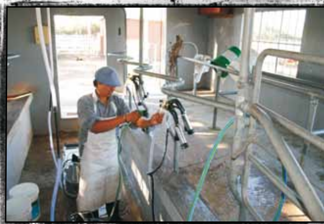
f Foto 3.26. Introducción de las pezoneras para iniciar la succión de agua e inicio del enjuague con agua fría y limpia.
