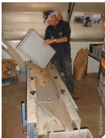
オランダでフリーズドライや包装前に分別されるミールワーム。
