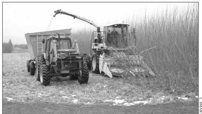
Mise à l'essai d'un système de récolte des saules arbustifs, au moyen d'une récolteuse-hacheuse autotractée munie d'une tête de fauchage modifiée
