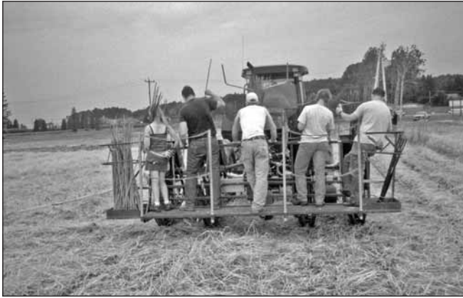
Plantation de saules dans un champ de seigle d'hiver, à l'aide d'une planteuse mécanique reliée à un tracteur
