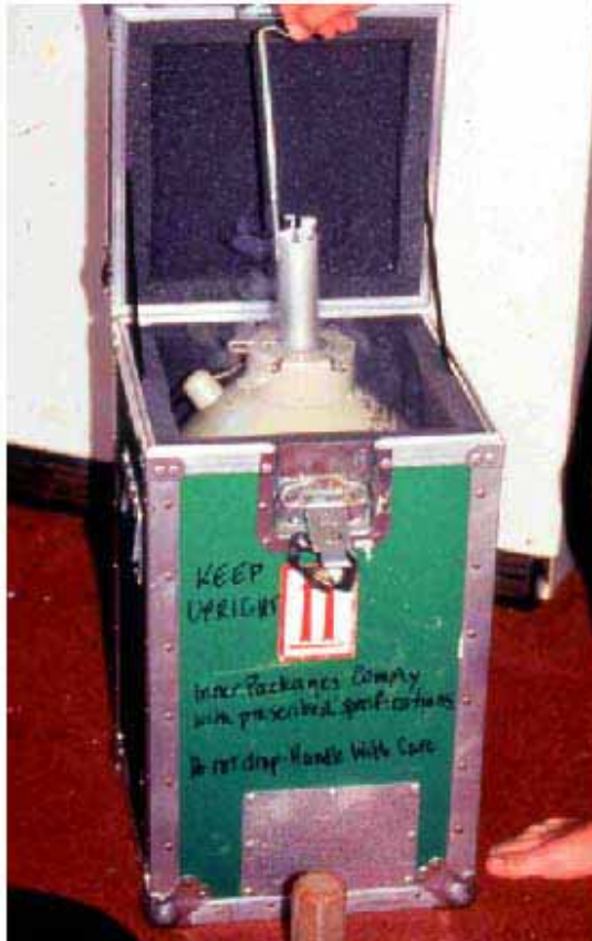
চিত্র ৫.৭ দুরবর্তী জায়গায় কাজ করার সময় নমুনা সংরক্ষণের জন্যে ব্যবহৃত ডরল নাইট্রোজেন কনটেইনার
