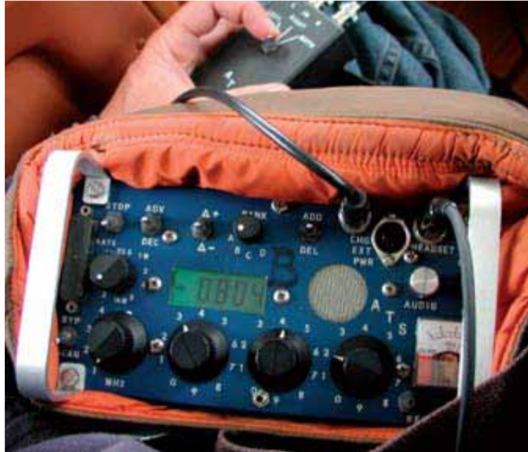
FIGURE 7.7 Récepteur VHF et boîtier d'interrupteur utilisés pour le suivi aérien dans les études classiques de télémétrie
