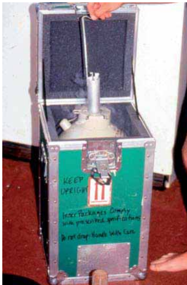
FIGURE 5.7 Récipient à l'azote liquide pour congeler et conserver des échantillons lors du travail dans des sites éloignés
