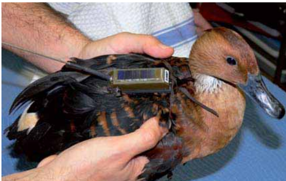
FIGURE 7.4 Émetteur télémetrique attaché par moyen d'un harnais dorsal
