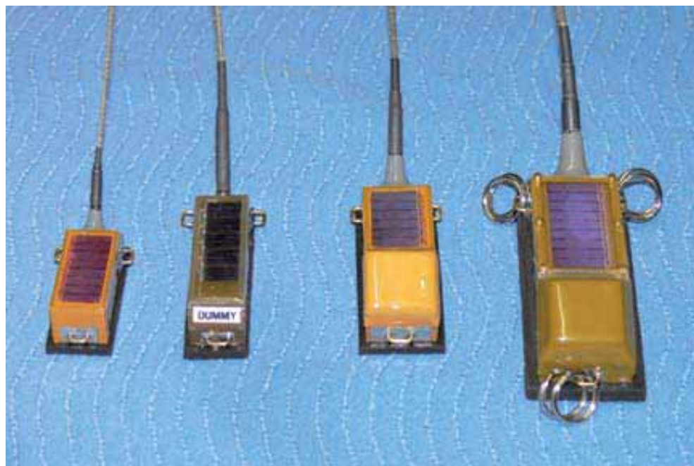
FIGURE 7.2 Terminal de l'émetteur de la plate-forme (PTT; les trois à gauche); Émetteur de GPS (Global Positioning System) (celui à droite)
