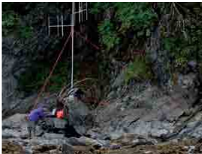
GAMBAR 7.9 Antena Yagi dipasang pada menara stasion terpencil yang dihubungkan ke penyimpanan data
