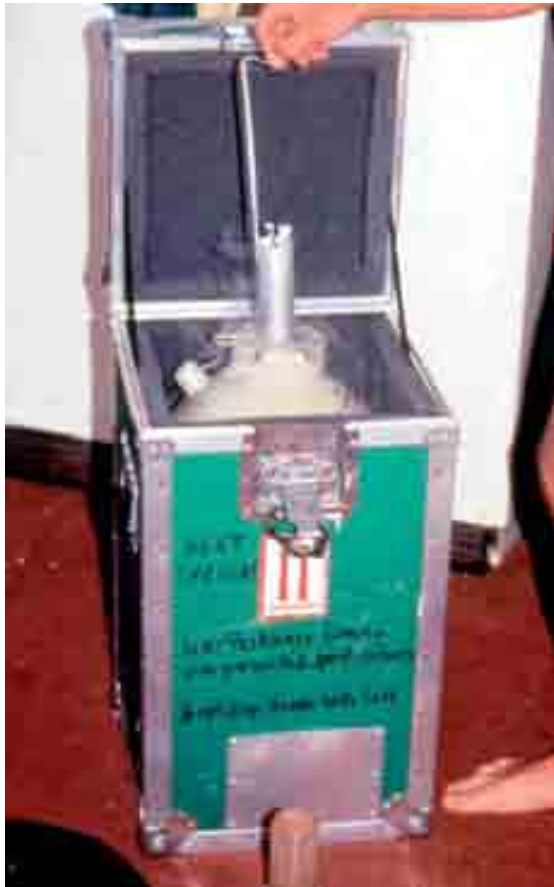
GAMBAR 5.7 Kontainer nitrogen cair yang dipakai untuk membekukan dan menyimpan sampel ketika bekerja di lokasi yang jauh.
