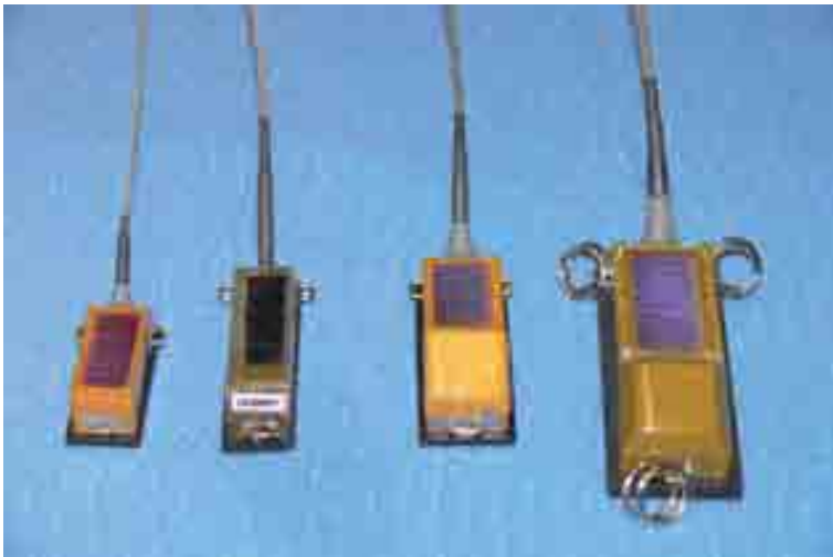
GAMBAR 7.2 Platform terminal transmitters (PTT; tiga sebelah kiri); pemancar Global Positioning System (GPS) (satu sebelah kanan)
