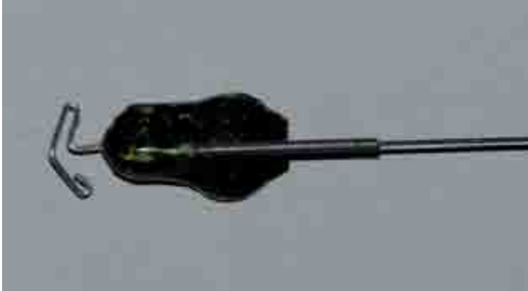
GAMBAR 7.1 Pemancar radio VHF yang ditanamkan pada burung
