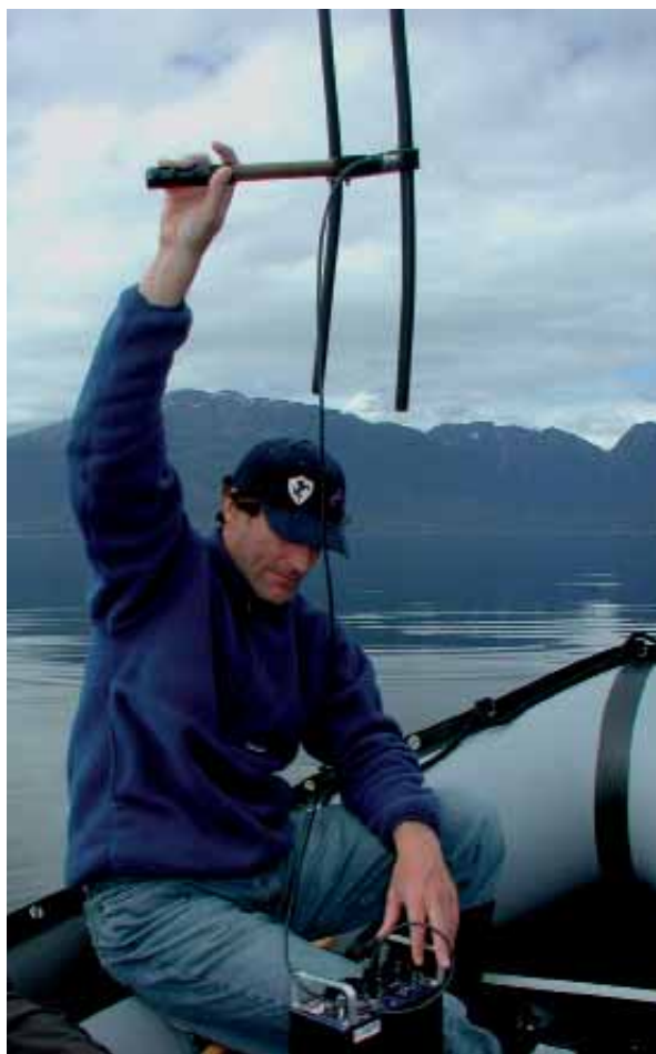
РИСУНОК 7.10 Ручная антенна Adcock H
