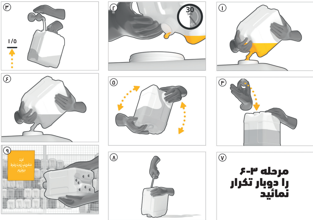
شکل ۲۳. روش شستشوی سه گانه برای ظروف حشره کش ها نیکه منشأ آبی دارند(دراب حل میشوند)
