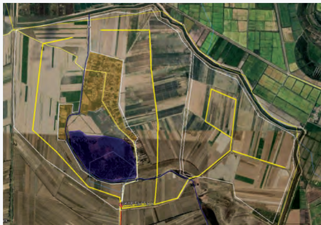
Концепция трех закрытых трубопроводных систем для подачи воды насосами из резервуара, расположенного на концевом участке канала второго порядка K18, Махтааральская система
