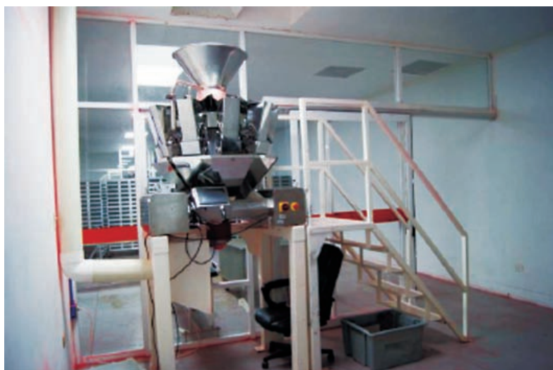
图5.5 虫蛹分装器（©FAO/Mubarqui 航空服务）
