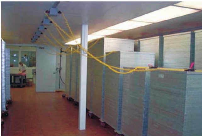
图5.3 用于不育蝇羽化和保存的沃力塔式羽化箱（©FAO/USDA项目，得克萨斯州）
