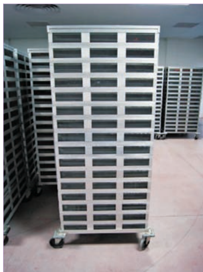
图5.4 用于不育蝇羽化和保存的墨西哥塔式羽化箱（©FAO/Moscamed项目，墨西哥、危地马拉、美国）
