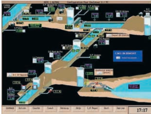
图 27 普罗旺斯运河：渠道和水库系统状况的实时显示
