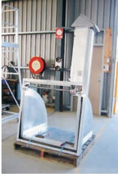
29 澳大利亚：工厂里便于站点运输的卢比肯闸门
