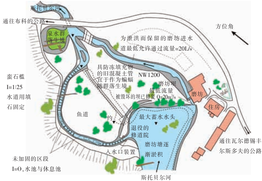
图 4.23 塞弗特氏磨房坝位置示意图。虽然以前的磨房坝不再用来发电，但磨房塘作为调节池及为了保护已兴盛的湿地群落生境必须予以保留，在磨房坝附近修建了一条长 120m、运送总流量达平均高水流量的旁路水道。总高度差为 3.3m 意味着，水道底必须用卵石槛分段加固。其他区段显示零坡度，没有加固。自然改变能形成水池、陡岸和淤积
