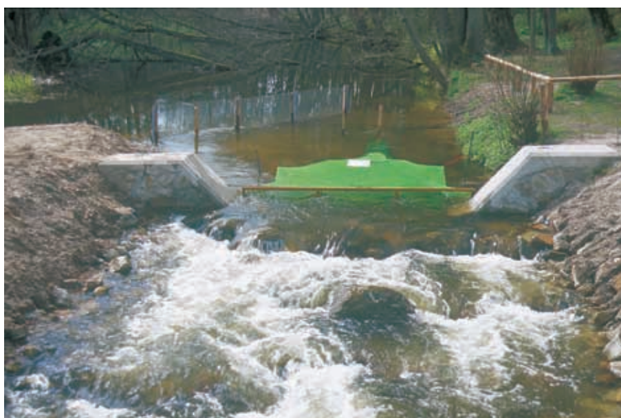
图 6.1 设置鱼张网监测施托伯河（勃兰登堡）上普里茨哈格内尔磨坊旁鱼道的运行
