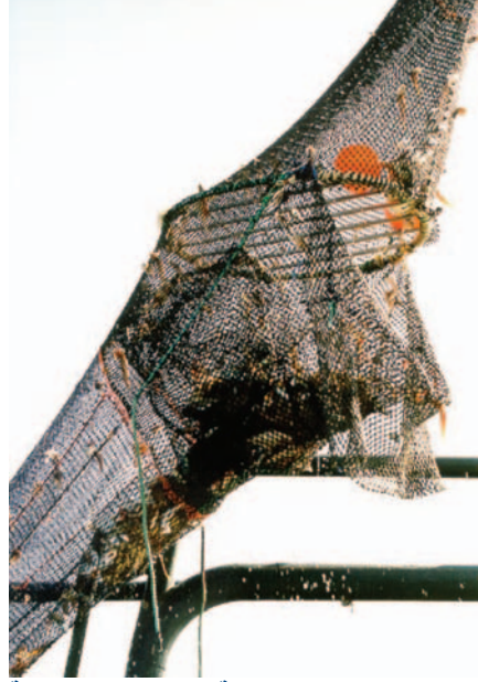
تلاؤم الحواجز البيضاوية شكل كيس الشبكة الاسطواني. لاحظ فتحة الهروب والجزء البارز من جانب الحاجز
