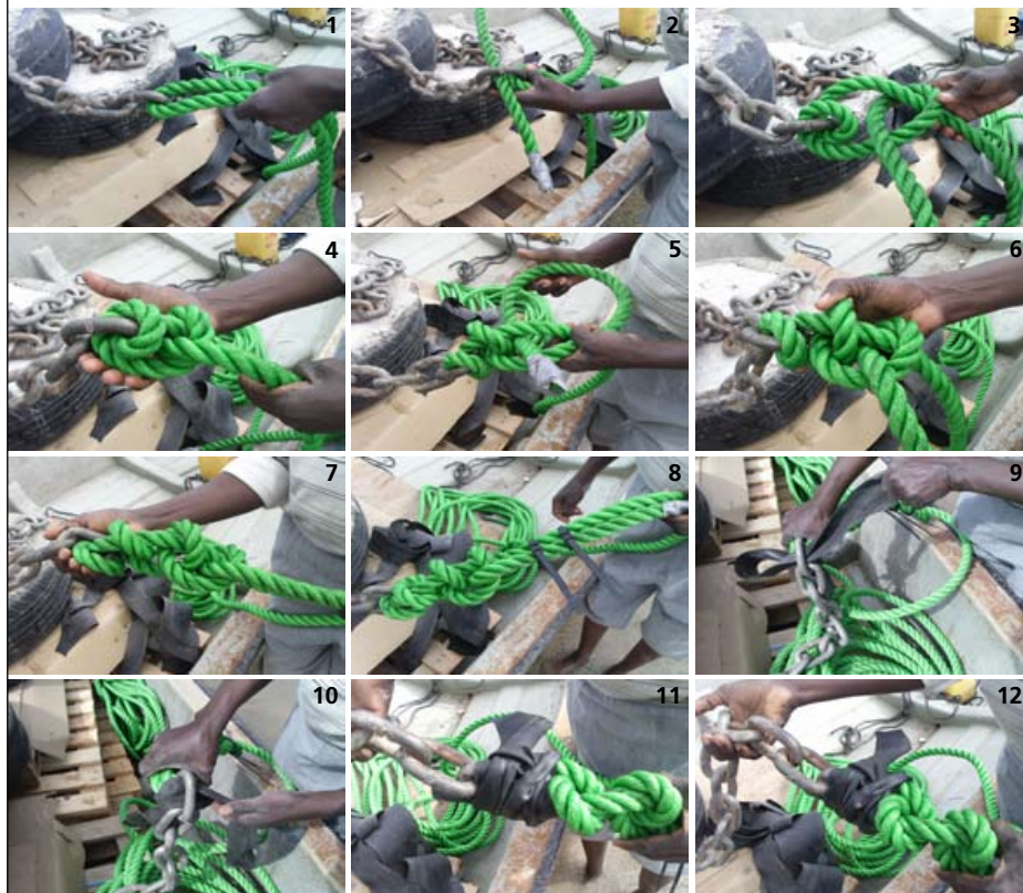
PLANCHE 35 Séquence pour lier correctement l'aussière à la maille de la chaîne et la protéger des frottements
