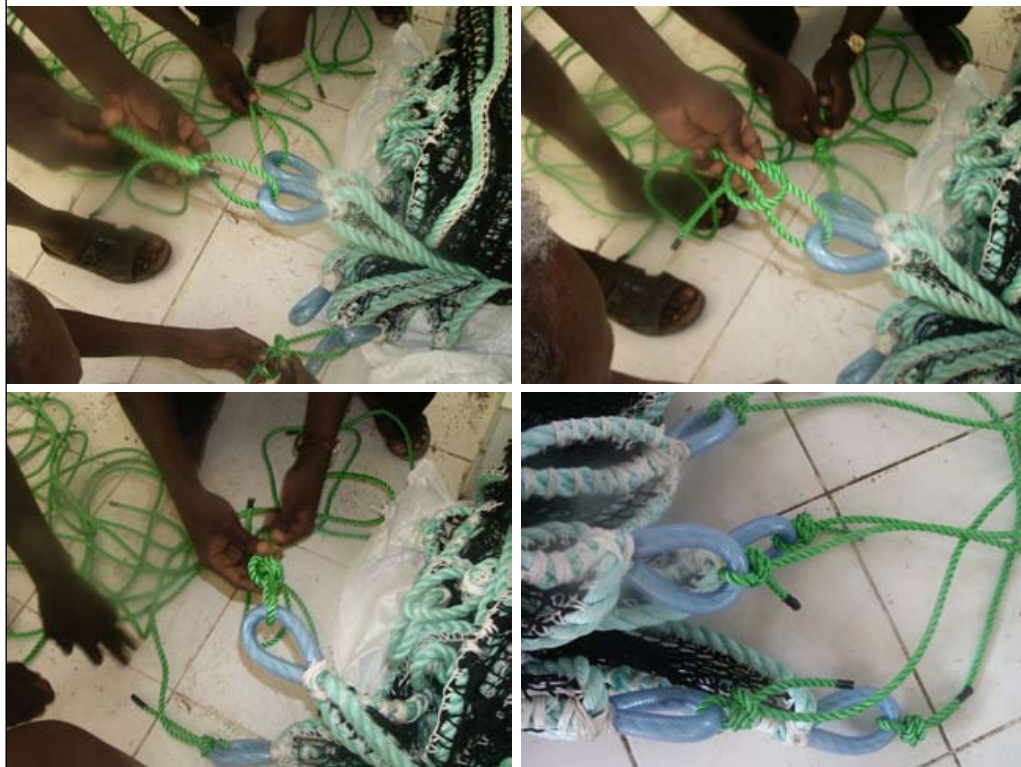
PLANCHE 43 Nœuds utilisés pour lier les cordes sur les anneaux du filet
