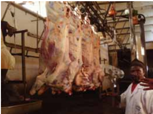
Photo 1. Rail de suspension dans un abattoir de bovins
