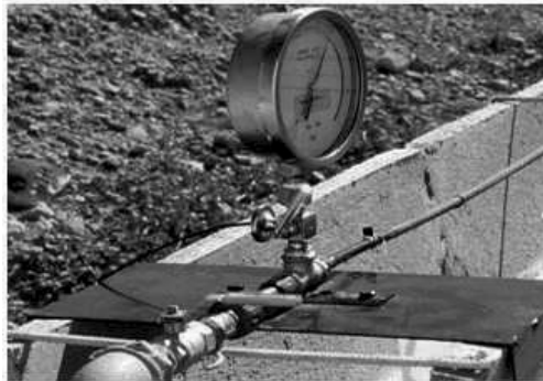
FIGURE 3.15 - Manomètre de type BOURDON.
