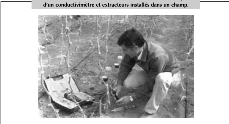
FIGURE 3.41 - Mesure directe des solutions du sol au moyen d'un conductivimètre et extracteurs installés dans un champ.
