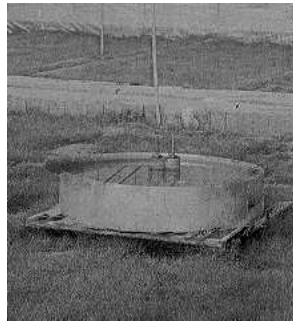
FIGURE 3.42 - Un bac d'évaporation de classe A sur le terrain.
