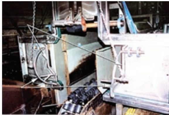
FOTO 7.2 Inmovilizador de ganado con transportador de monorriel a) Elevador de mentón, b) Monorriel, c) Inmovilizador de cuello
