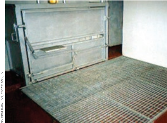
FOTO 10.2 BUENAS PRÁCTICAS: corral de aturdimiento para bovinos con rejilla alta para mantener a los animales lejos del piso y reducir la contaminación de la piel
