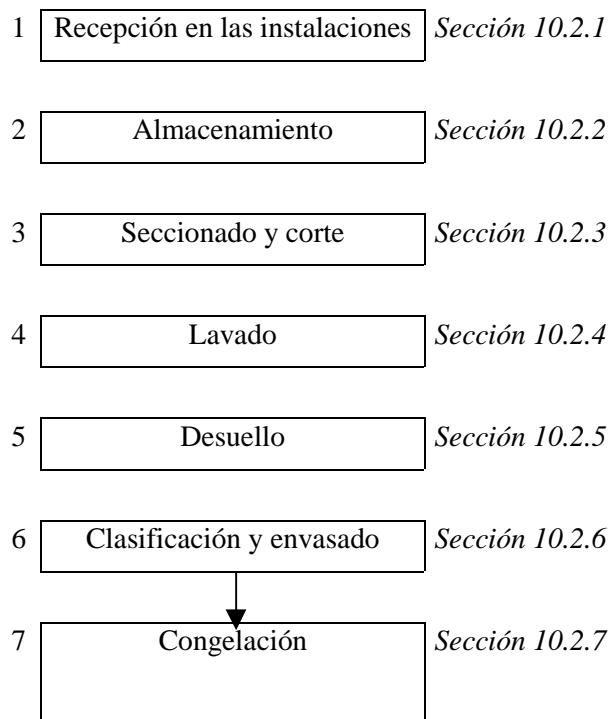
Figura 10.1 Ejemplo de diagrama de flujo de una cadena de elaboración de cefalópodos frescos para obtener productos congelados
