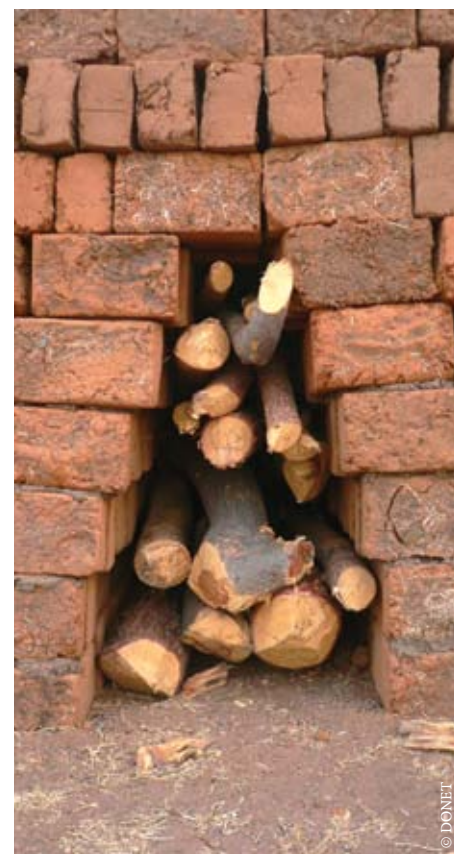
Four à briques en terre. ►
