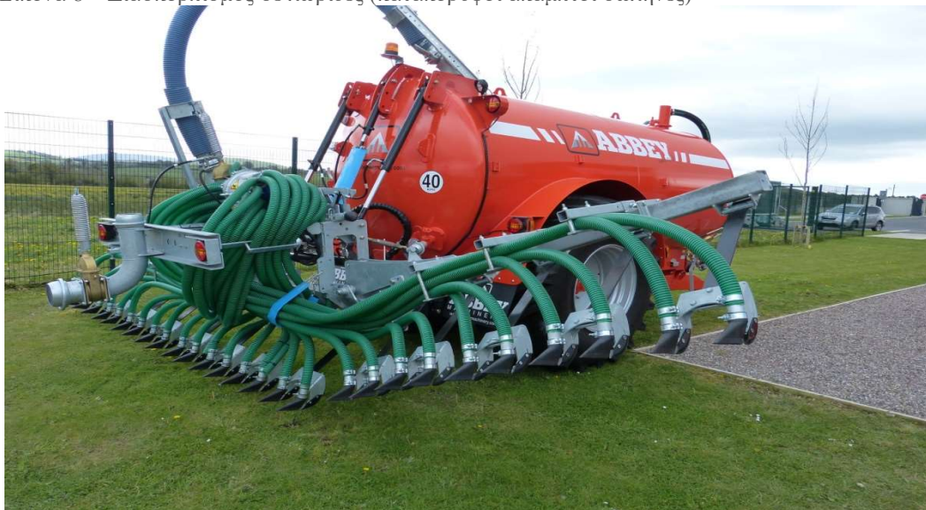
Εικόνα 8 – Διασκορπισμός σε λωρίδες (κατακόρυφοι άκαμπτοι σωλήνες)
