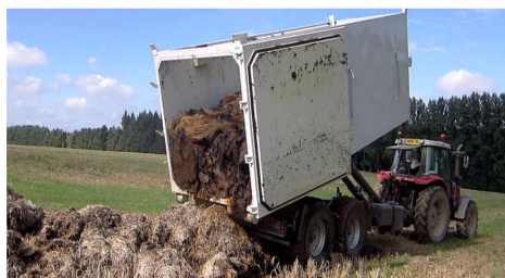
Caisson de stockage d'effluents
