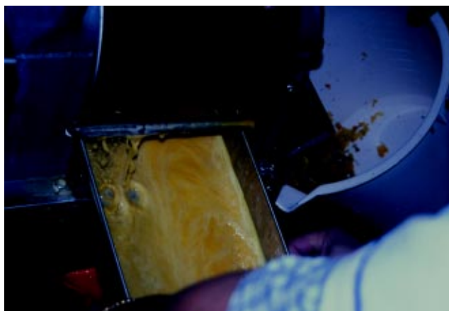
Despulpado de frutos de arazá en despulpadora horizontal
