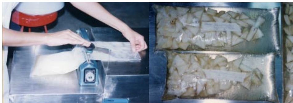
Empacado y sellado de pulpa de piña en polietileno tubular
