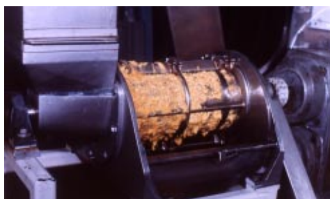
Despulpado de maraco en despulpadora horizontal
