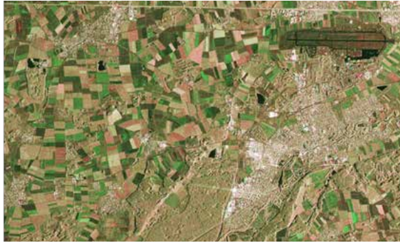
Fig. 8: Imagen del norte de Múnich con la codificación de colores de TerraSAR. Datos adquiridos el 26 de junio y el 7 de julio de 2007, 5:26 UTC, resolución: 3 m, modo: StripMap, polarización: VV y HH (fuente: DLR, Alemania)
