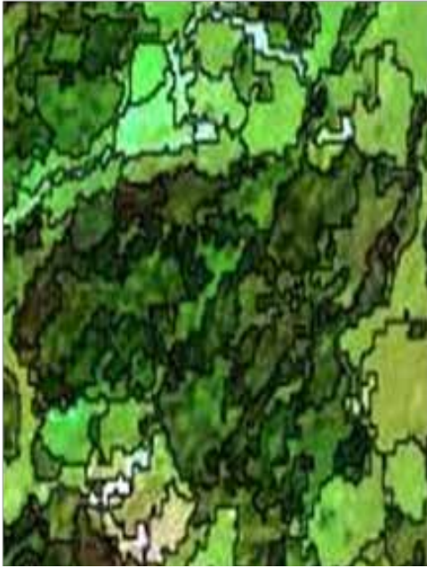
Fig. 6: Segmentación de área forestal basada en imágenes fusionadas de IRS-1D y Landsat TM (fuente: Ivits et al. 2004)
