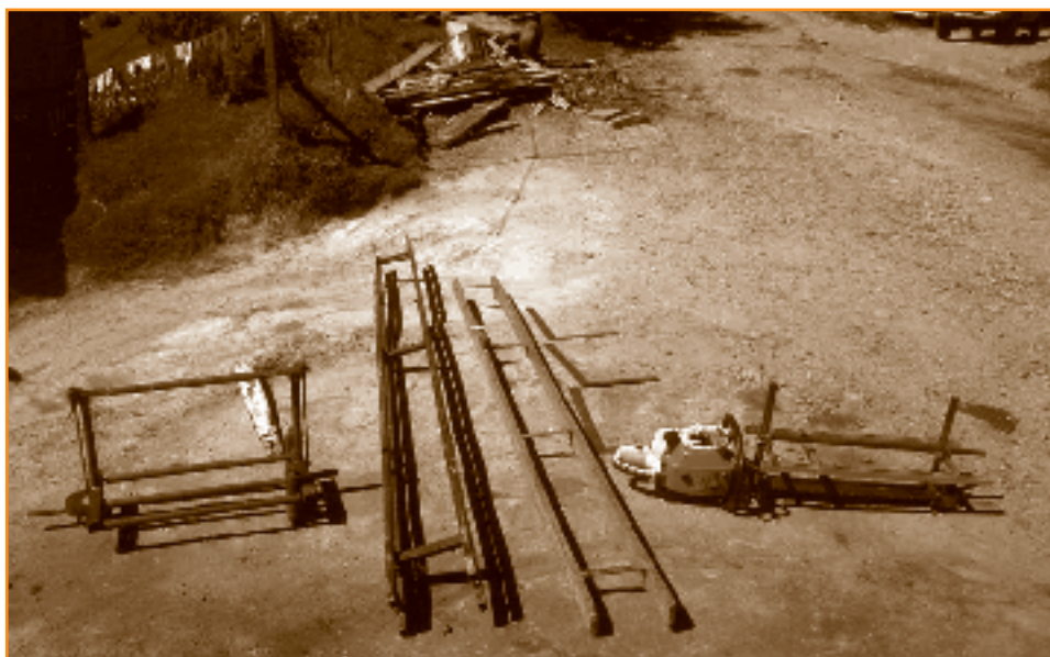
Foto 9.1 Equipo básico para el aserrío: motosierras, marcos, codales y escuadras
