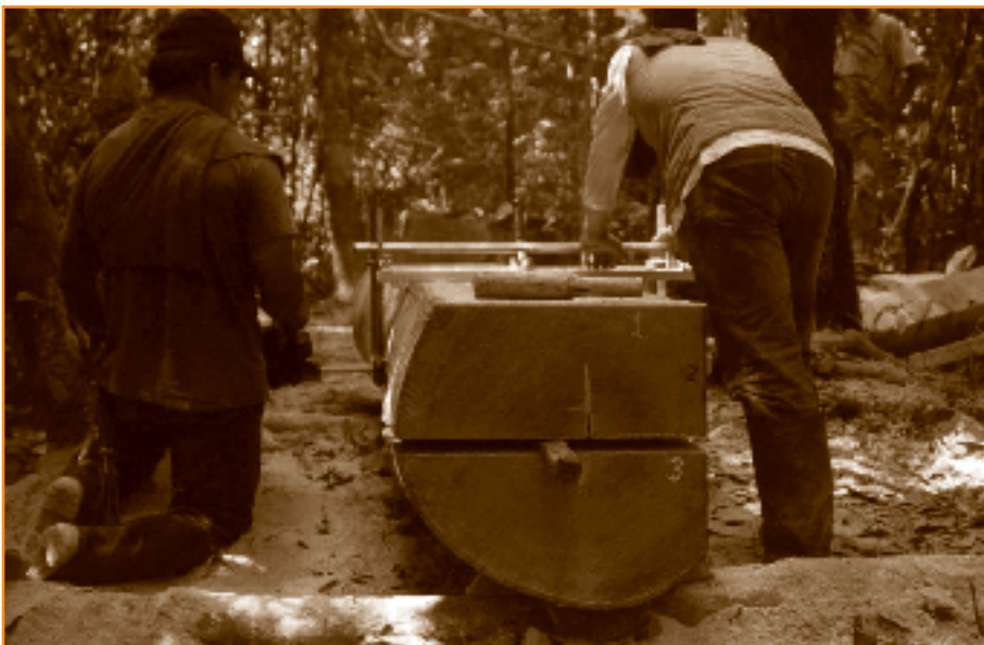
Foto 9.13 Avance del tercer corte. Se observa el uso de cuñas para evitar el prensado de la cadena.
