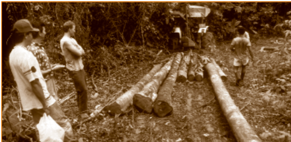
Foto 6.5 Tractor agrícola arrastrando varios fustes de diámetros menores en un aprovechamiento forestal de la zona norte de Costa Rica
