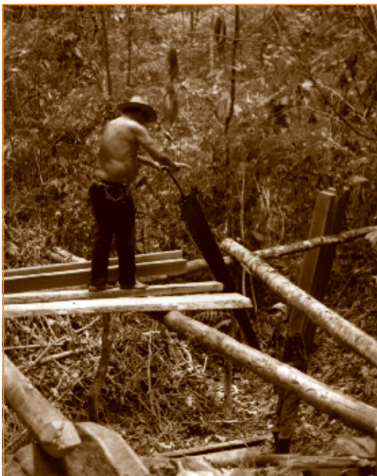
Foto 8.5 Aserrío con sierra de viento en Toncontín, La Ceiba, Honduras. Nótese la cantidad de fustes requeridos para la construcción del banco de aserrío.
