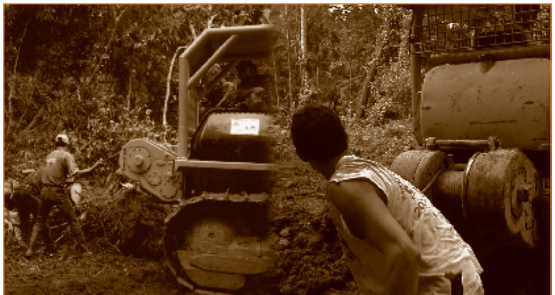
Fotos 6.3 Amarre y posición del tractor para el wincheo de fustes en un aprovechamiento de la zona norte de Costa Rica
