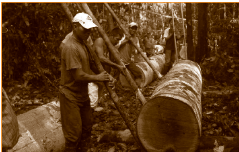
Foto 9.6 Uso de giratrocas o palancas en el acomodo de la troza
