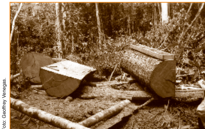
Foto 9.5 Troza cortada o desguapada longitudinalmente. A la derecha se observa la mitad de la troza en posición de aserrío.
