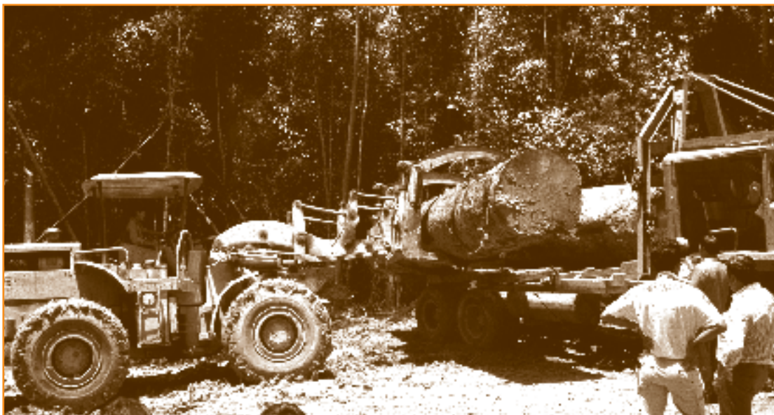
Foto 7.4 Cargador frontal en plena actividad de carga. Es la máquina más eficiente para estas labores.
