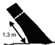
Figura 16. Posición para la medición del Dap de un árbol inclinado.
