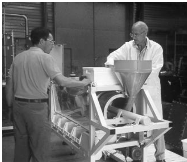
Jacques Faure "en blouse blanche" faisant des essais de fabrication de couscous de sorgho ou de mil avec un rouleau mis au point au Laboratoire de Technologie des Grains au CIRAD-CA.
