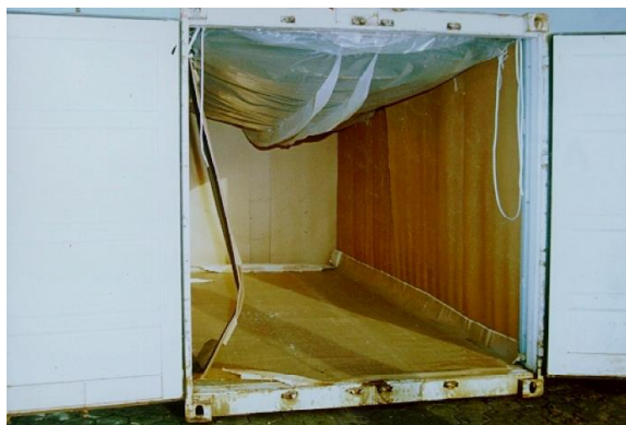
Fig. 16 Contenedor recubierto con papel y plástico para proteger al producto de la acumulación de humedad por la transpiración del grano (TIS, 2010)
