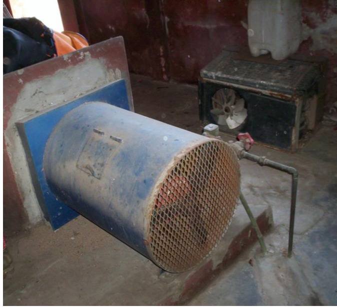
Fig. 21 Secador mecánico para deshidratación de cacao fermentado (Chocolatería Wolter, 2010)
