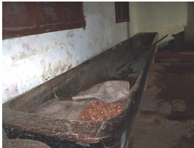
Fig. 19.- Fermentación de granos de cacao y pulpa dentro de fermentador tipo canoa (Chocolatería Wolter, 2010)
