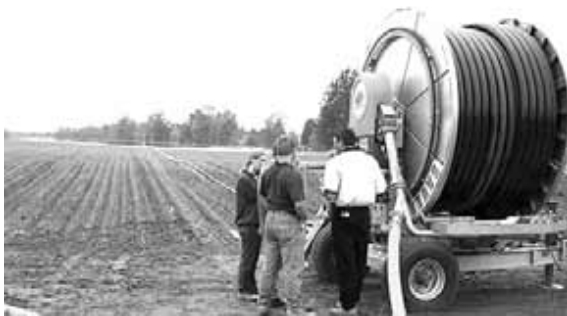
FIGURE 9.4 - Le bâti à tambour et le tuyau flexible en PE.
