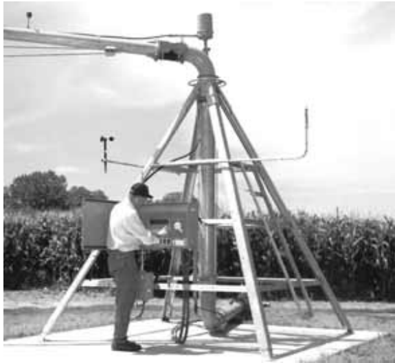
FIGURE 10.4 - La tour centrale et le panneau de commande.
