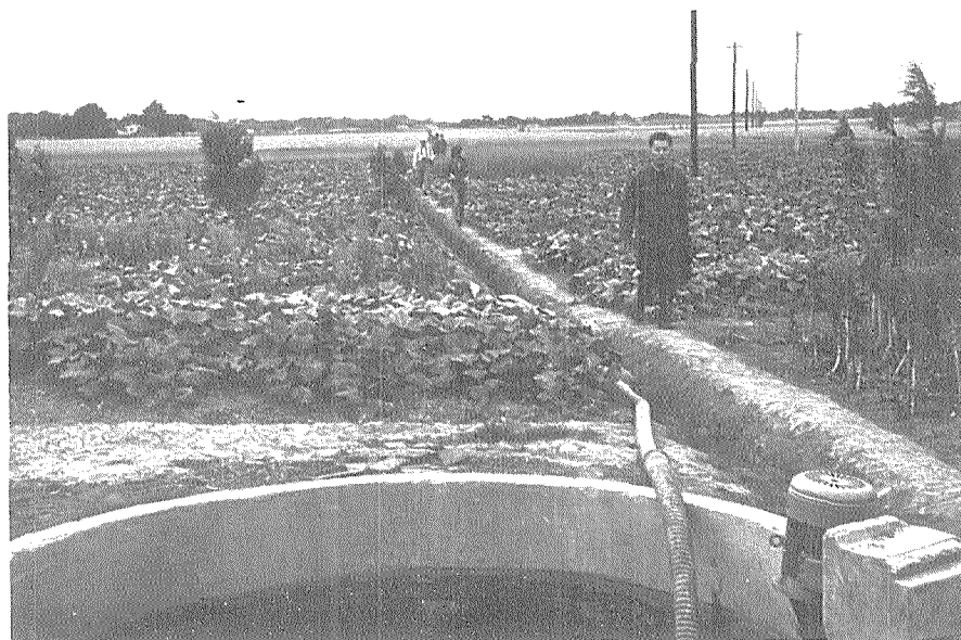
Fotografía 27. Una bomba accionada a gas extrae el efluente de una gran unidad de biogas para rociarlo directamente en los campos (Comuna del pueblo de Pin Niu, provincia de Jiangsu).
