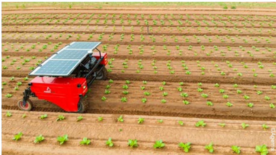
Figure 6. Robot à énergie solaire (Agerris Farmhand, Australie)
