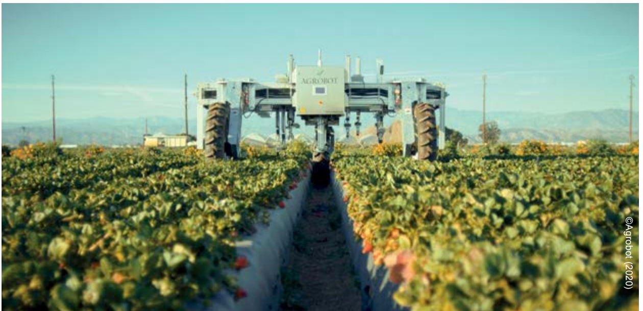
Figure 9: Robot agricole spécialisé pour la récolte de fraises
