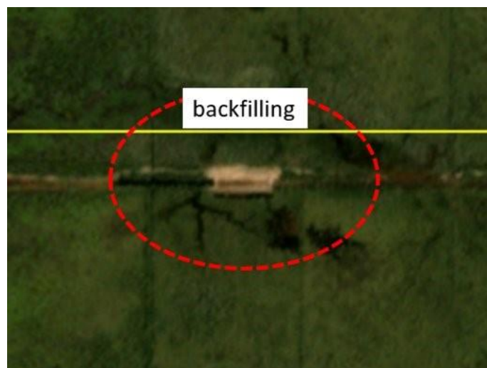
Gambar 2. 5. Contoh penggunaan data satelit beresolusi tinggi untuk memantau penyekatan kanal dan penimbunan saluran.
