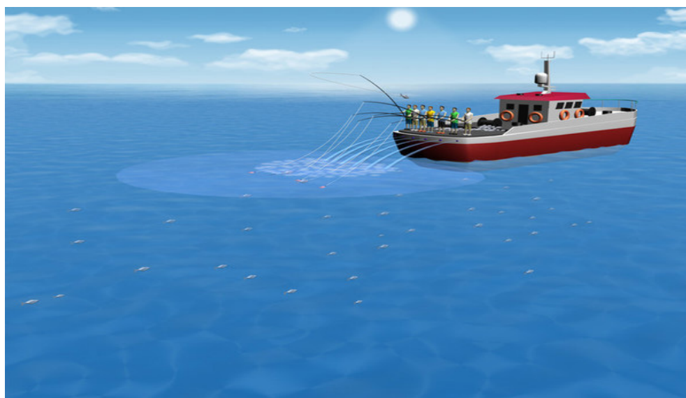
FIGURE 50 Pêche au thon listao ( Katsuwonus pelamis ) avec des lignes à main et lignes à cannes manœuvrées à la main (LHP 09.1) utilisant des poissons appâts et des jets d'eau. Les jets d'eau proviennent de la poupe du bateau (sous les pêcheurs).
