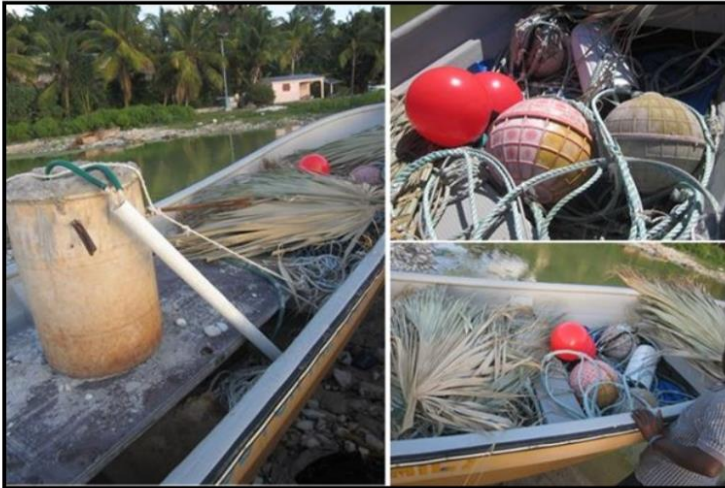
Figura 3. Componentes de anclaje y flotación para DCPf ligero, listos para su despliegue en la República Dominicana (imagen superior) y Haití (imágenes inferiores). Fotografías obtenidas de Gertner et al. (2018) y Vallès (2015) respectivamente (Apéndice I).
