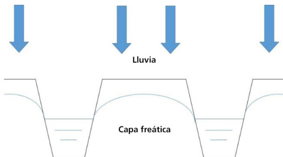
Figura 9. Sistema de drenaje superficial por zanjas abiertas
