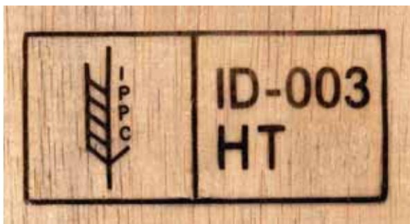
Пример маркировки МККЗР на древесном упаковочном материале, включая: символ согласно МСФМ № 15, код ИСО страны из двух букв (ID - код Индонезии), уникальный код, присвоенный НОКЗР производителю, и код обработки согласно МСФМ № 15 (HT – код тепловой обработки)
