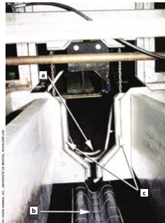
PHOTO 7.3 Contention verticale des bovins sur un rail (vue de l'intérieur) a) élévateur pour la tête, b) rail, c) contention du cou
