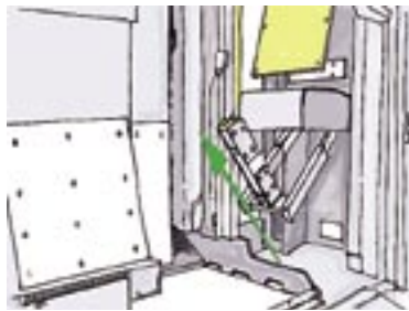
FIGURE 7.13 BONNE PRATIQUE: Vue de profil d'une cage d'étourdissement électrique pour bovin avec les électrodes en position de marche
