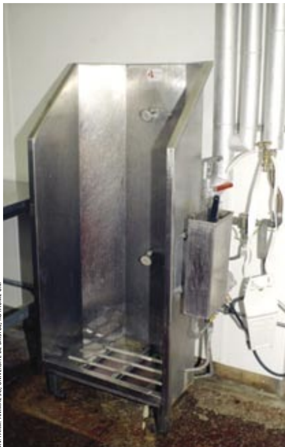
PHOTO 10.1 BONNE PRATIQUE: lave-tablier en acier inoxydable avec un stérilisateur pour les couteaux
