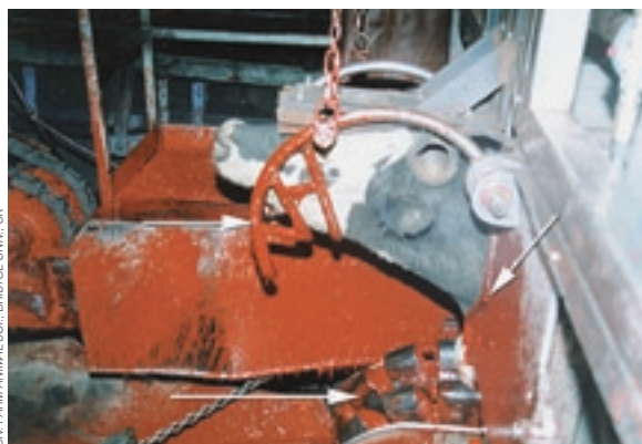
FOTO 7.4 Inmovilizador vertical: desangrado por método religioso, a) Elevador vertical, b) Monorriel, c) Inmovilizador de cuello
