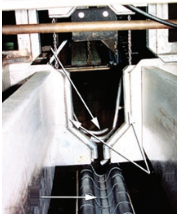
FOTO 7.3 Inmovilizador vertical con monorriel (vista interna), a) Elevador de mentón, b) Monorriel, c) Sujetador de cuello
